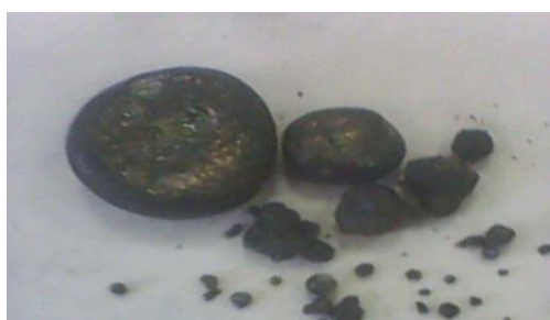
Рисунок 3а. Восстановленный металл из шлама радиальных отстойников
