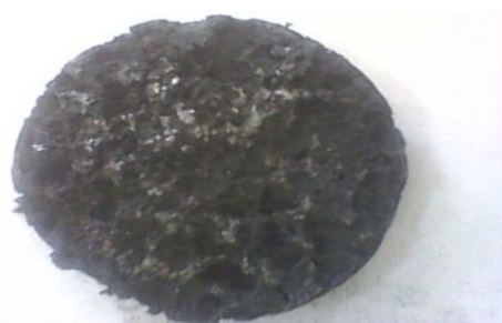
Рисунок 3б. Слиток металла, полученный при нагреве окалины с коксом с помощью древесного угля
